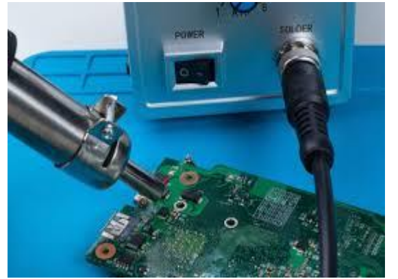
চিত্র : SMD রিওয়ার্ক স্টেশন দিয়ে ঝালাই পদ্ধতি
